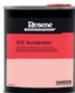
62C Accelerator è un additivo per i prodotti Durepox. Grazie all'aggiunta di un 5% massimo, in volume, di 62C Accelerator, i tempi di indurimento e pot life risultano approssimativamente dimezzati.
