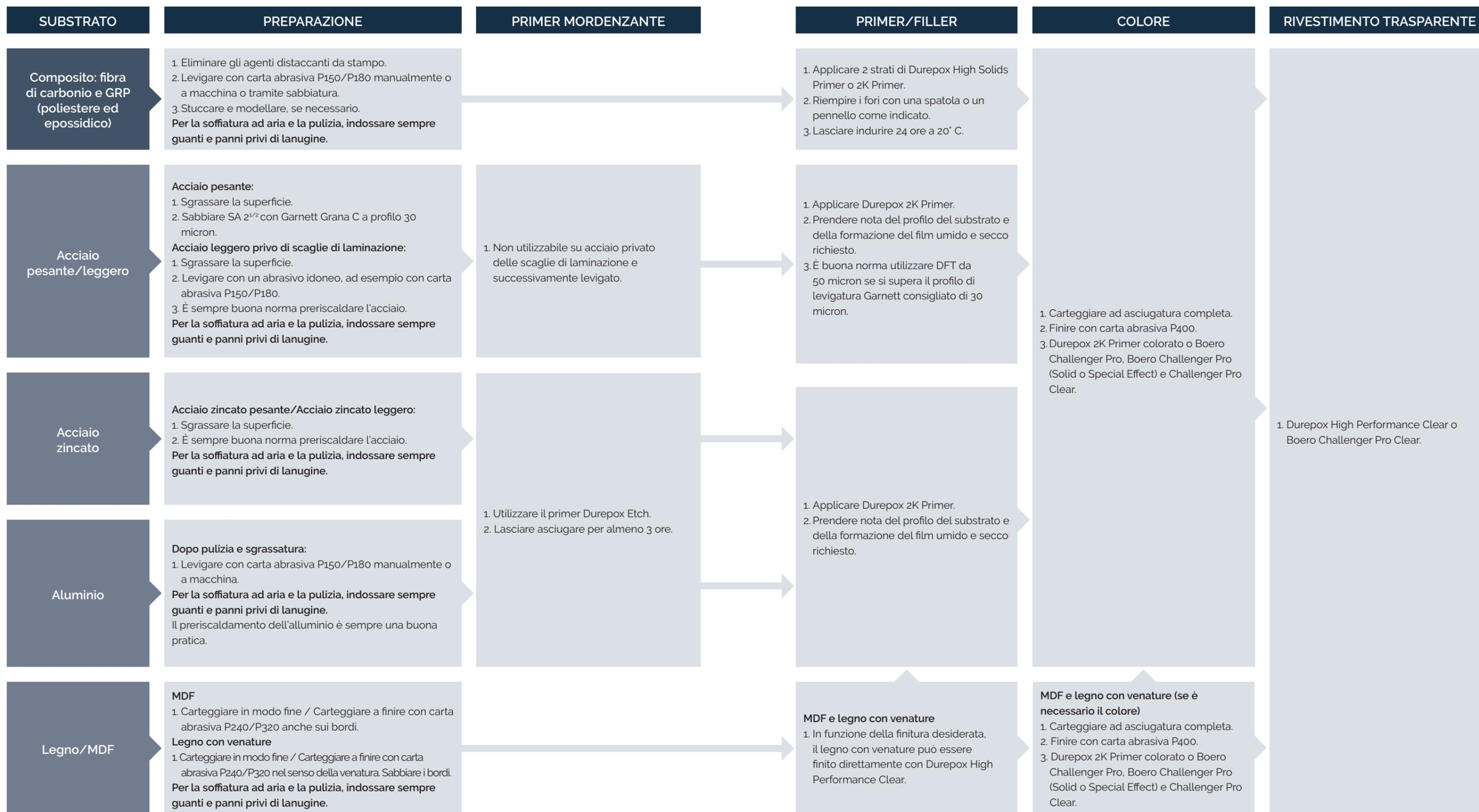
Durepox 2K Primer è un eposs-uretanico bicomponente, unico nel suo genere, che può essere applicato tramite pennello, rullo, spruzzo convenzionale ed elettrostatico o a pressione, airless e misto aria. Prevede numerose applicazioni, dal primer hi-build, all'impiego come smalto colorato in abbinamento a Durepox High Performance Clear (DHPC). Gli altri smalti 2K sono applicabili a Durepox dopo trattamento accurato e carteggiatura, testando la superficie prima di completare l'intervento.
